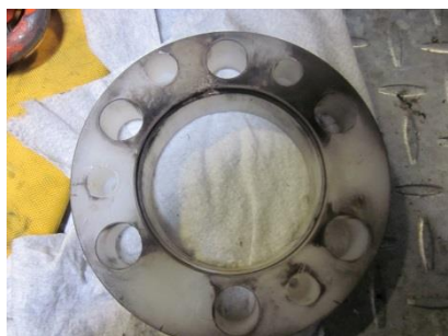
Bränd släpring från generatormotorn på Gudrun.
